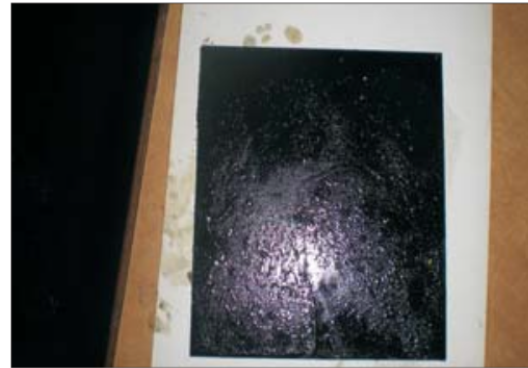
Bajo la foto derecha Después de 30 minutos de inmersión en ácido – sin efecto.
